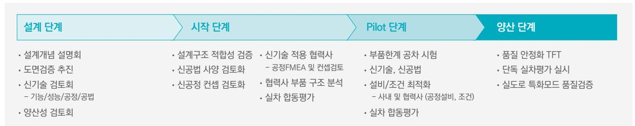
현대위아는 품질강화를 위해 1차, 2차, 3차 협력사로부터 구매하는 모든 원자재에 대해 철저한 검증절차를 진행합니다. 원자재 성분, 재질, 유해물질 확인을 위하여 신규개발부품은 ISIR 검사를 통해 검사 및 검증을 진행하고 있으며, 양산부품은 검사주기에 따라 매년 정기검사 계획을 수립하여 검사 및 검증활동을 진행합니다. 검증결과 부적합 판정 시, 부적합품 처리프로세스에 따라 해당 부적합품의 격리 및 부적합 판정 원인을 식별하고 재발방지를 위한 시정조치 활동을 전개합니다. 차량부품 중 보안부품은 연2회 실시하고 있으며, 중요 및 일반부품은 연1회 실시합니다. 현대위아는 주기적인 검사 및 검증활동을 통해 제품 품질을 안정화합니다.
